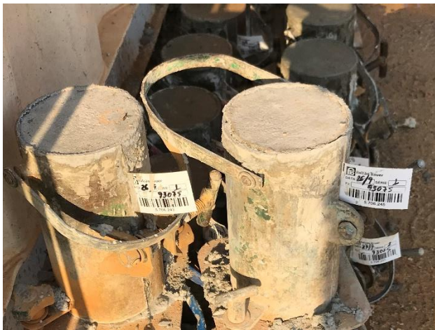
Controle tecnológico – corpos de prova de ensaios de concreto realizados pela Falcão Bauer
