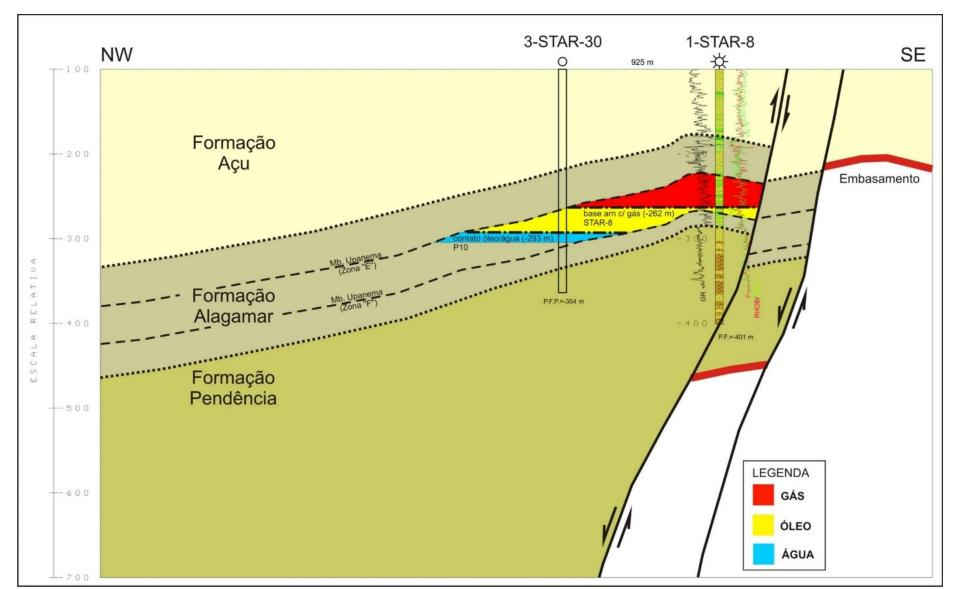
Seção geológica dip NW-SE ilustrando a possibilidade de coluna de óleo downdip na acumulação já descoberta, representando upside a ser investigado.
