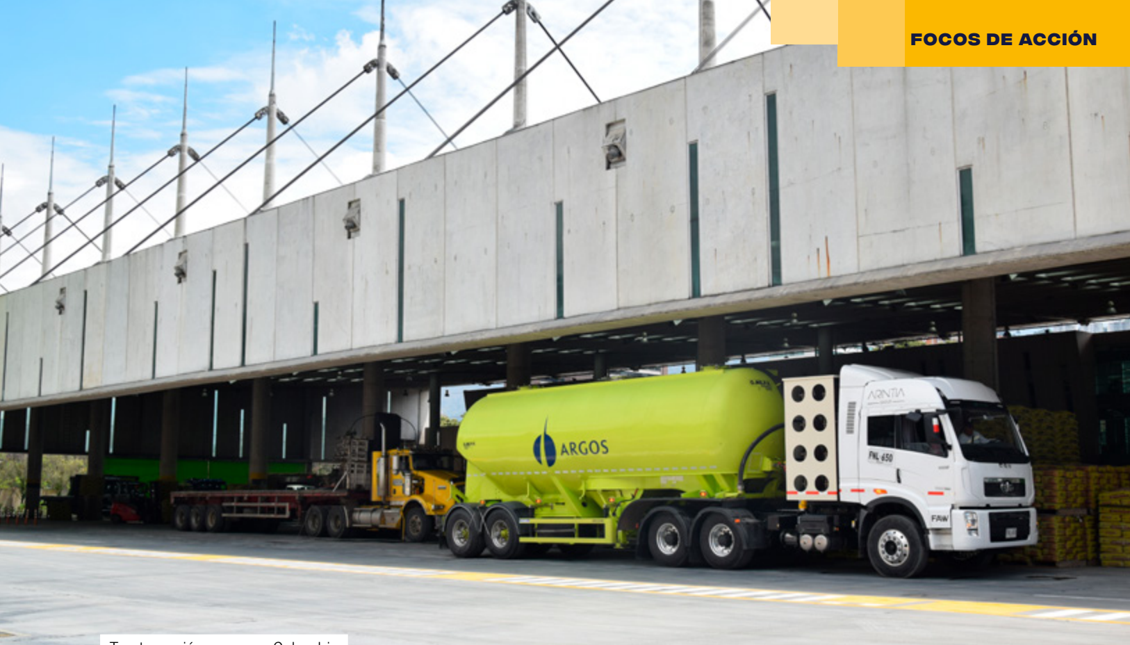
Tractocamión a gas en Colombia
