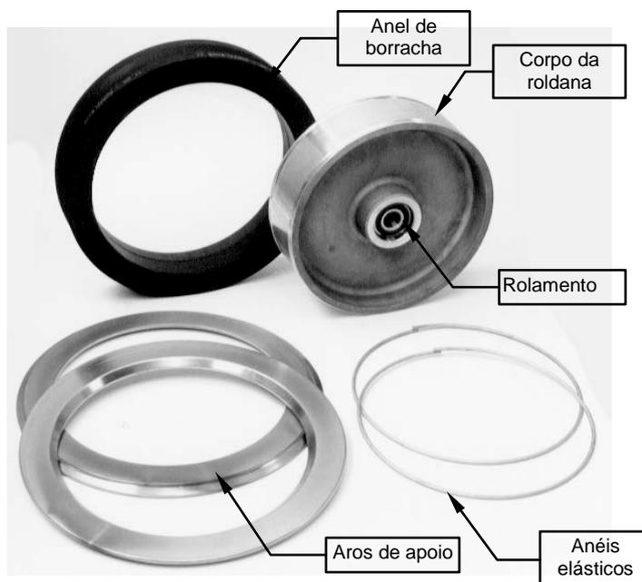
As roldanas do cabo são elementos sem parafusos e consistem em:
