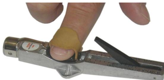
4. Se você sentir ou ouvir um clique evidente, imediatamente ajuste o valor da pressão, a agulha indicadora continua posicionada na posição da medição.
