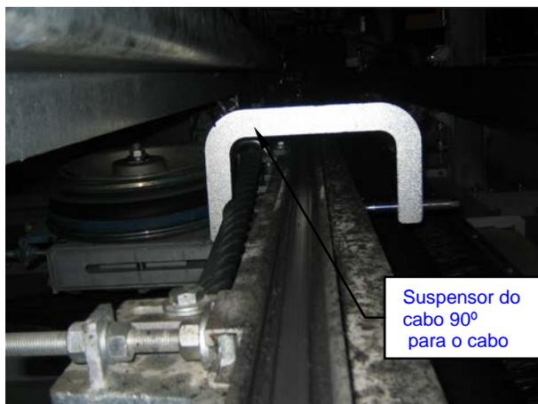
3. Girando o fuso (SW 17), levantar o cabo de transporte da roldana.
