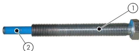
4. Colocar a ferramenta (1) e apertar. A unidade de acoplamento de freio é extraída do eixo
