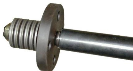
3. Prender uma barra de extração em uma pinça no cavalete de montagem ou pelas partes planas em um torno.
