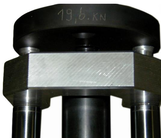
12. Ler a força no manômetro e comparar com a força indicada no equipamento de controle.
