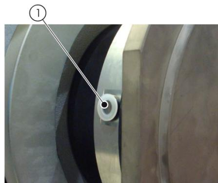
5. Montar conector (1) e fixar com parafuso (2)
