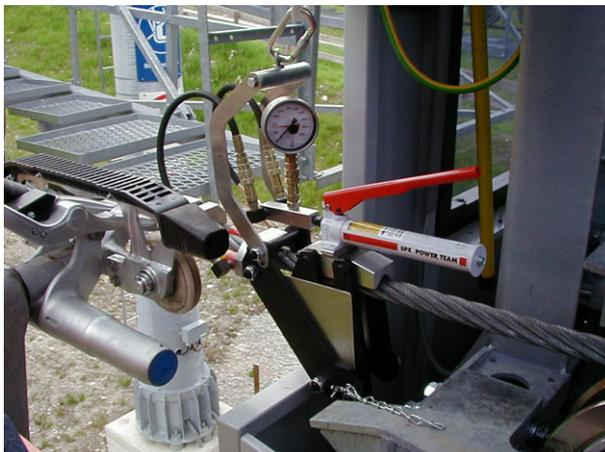
6. Colocar o adaptador com extrator nos pinos das rampas de subida.
