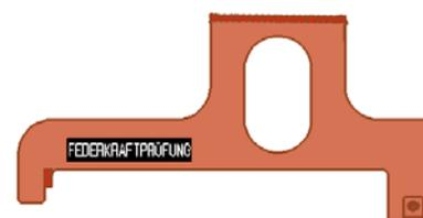
Gabarito de ajuste para ajustar a verificação elétrica da força de tensão da mola
