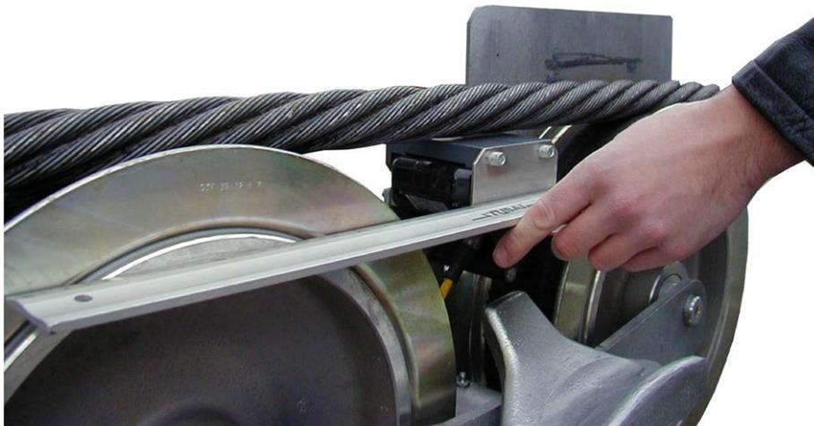
Com auxílio de uma régua (C=800 mm) é controlado o alinhamento do interruptor RPD relativamente ao corpo da roldana adjacente!
