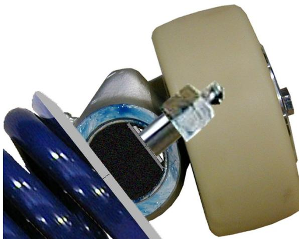
2. Remover a porca do aparelho de abertura, e puxar a barra roscada M18 da carcaça para fora.
