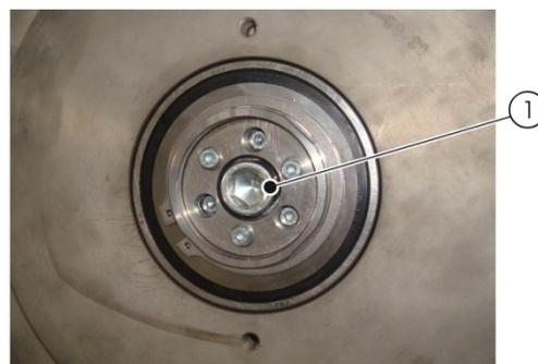
3. Lubrificar levemente a ferramenta (1) na ponta de eixo (2) com graxa de rolamento.
