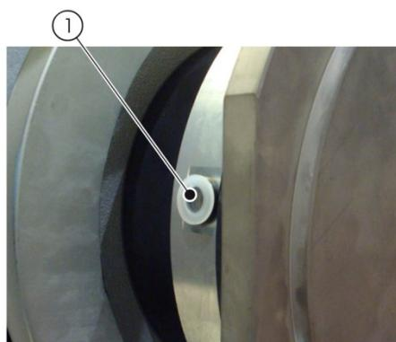
10. Montar conector (1) e fixar com parafuso (2)
