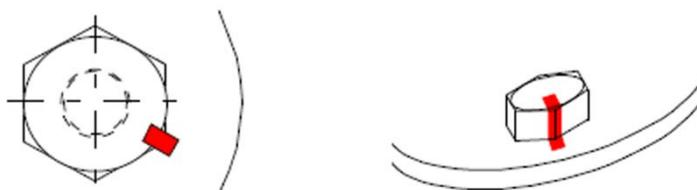
5. Apertar os parafusos com uma chave, até que o canto da cabeça de parafuso mais próximo à esquerda alcance a marcação no flange do eixo articulado.
