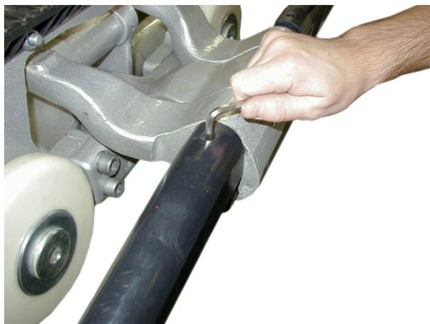
2. Encaixar a pinça de acoplamento no pino esférico e fixar com as cavilhas roscadas.
