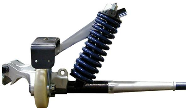
10. Desmontagem dos dois anéis de retenção. Os dois conjuntos de molas podem ser removidos da centralização (eixo DM 50) após desmontagem dos dois anéis de retenção.
