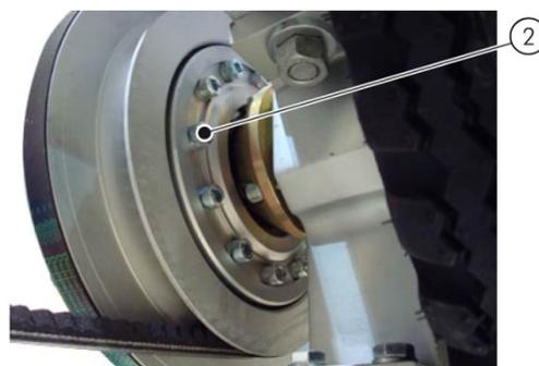
10. Colocar a nova unidade de acoplamento de freio com auxílio da ferramenta (2) e empurrar para cima do eixo; a seguir, remover a ferramenta (2).
