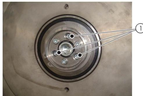
9. Montar conector (1) e fixar com parafuso (2)
