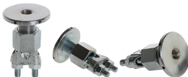
Conector ATERRINSERT com disco em latão, Rosca Fêmea M12 Com distância do condutor regulável de 25mm a 40mm
