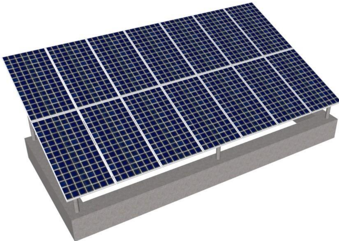
Figura 11 - Posicionamento das estruturas de suporte dos módulos FV.
