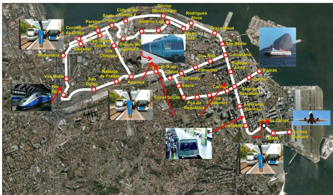
Figura 5.1.5.2 – Mapa das estações do VLT, inclusive as de integração com trens, metrô e barcas
