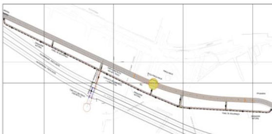
Drenagem do túnel de emergência
