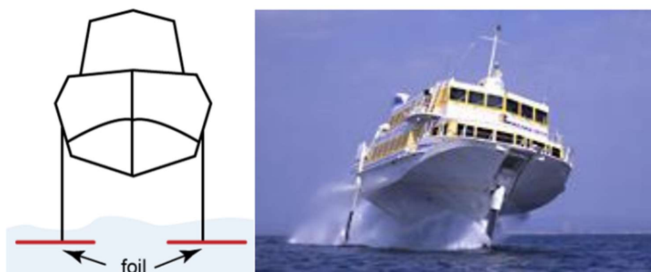
Figura 55 – Aerobarco com fôlios submersos Fonte: BORGES (2017)
