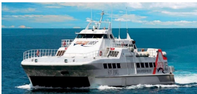
Figura 62 – Ilustração de uma embarcação SES Fonte: KASKUS (2019)
