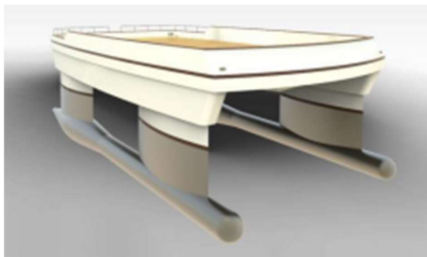
Figura 64 – Modelo de um projeto de um casco de uma embarcação SWATH Fonte: KASKUS (2019)
