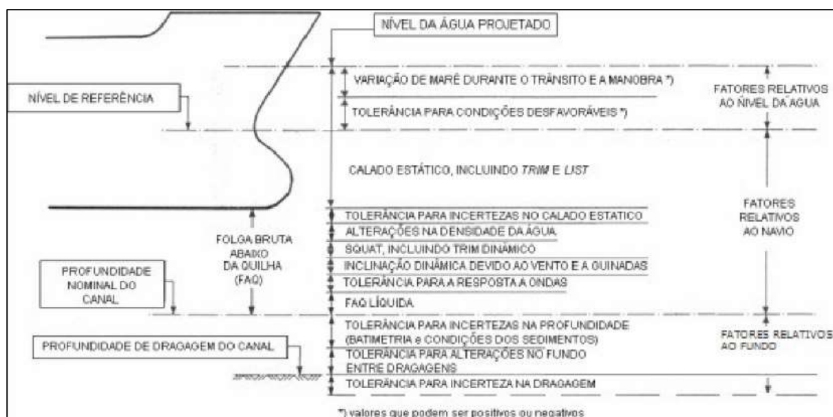
Figura 68 – Fatores para determinação da profundidade do canal Fonte: PIANC (2014)
