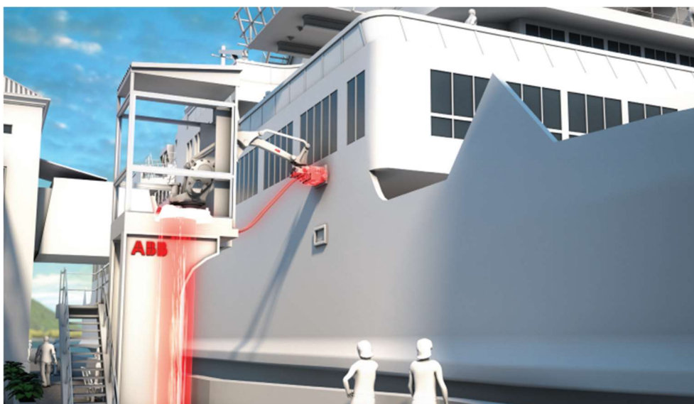
Figura 85 – Estação para carregamento de embarcações elétricas Fonte: ABB Group (2020)
