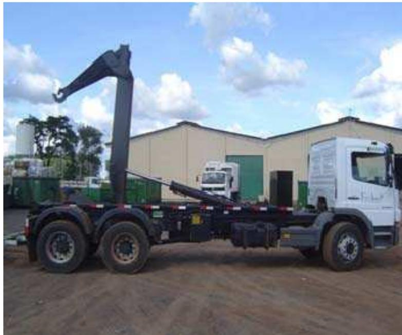
**Caminhão com dispositivo "roll-on / roll-off"**
