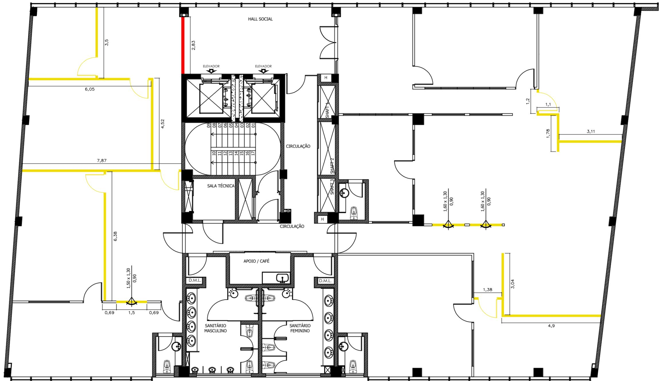
01 PLANTA DO 3º PAV. - DEMOLIR E CONSTRUIR
