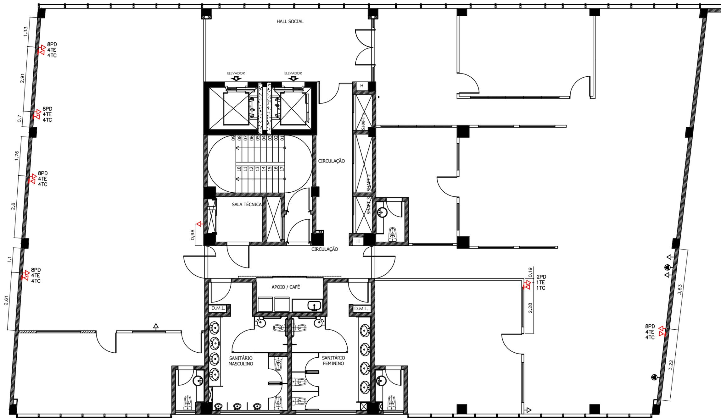
01 PLANTA DO 3º PAV. - PONTOS ELÉTRICOS E DE DADOS
