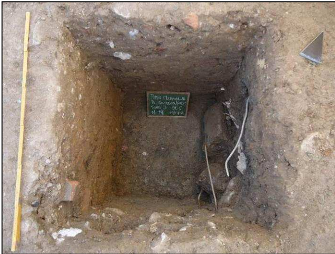
Sondagem 3 na profundidade máxima de 1,3 m, com escavação manual.
