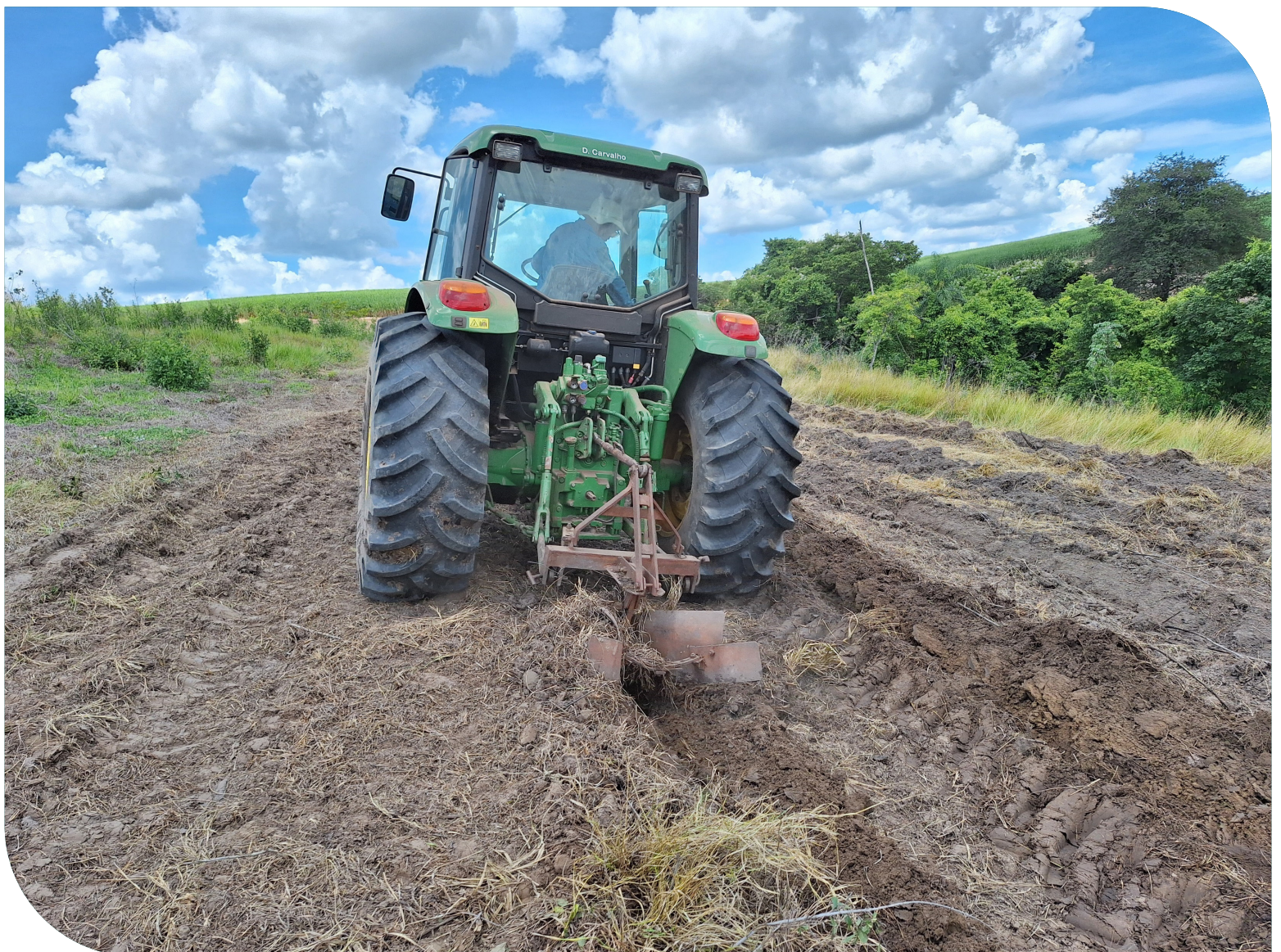
Figura 22. Preparo das linhas de plantio com sulcador do tipo enxada.
