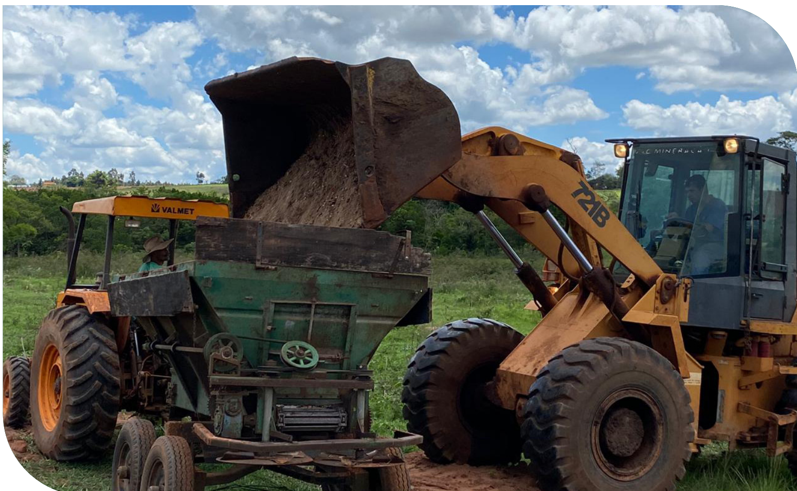
Figura 15. Carregamento mecanizado da mistura das sementes com areia na calcareadeira
