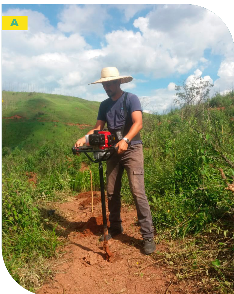
Figura 9. Abertura da cova com motocoveadora (a); Tipos de brocas utilizadas para plantio (b).
