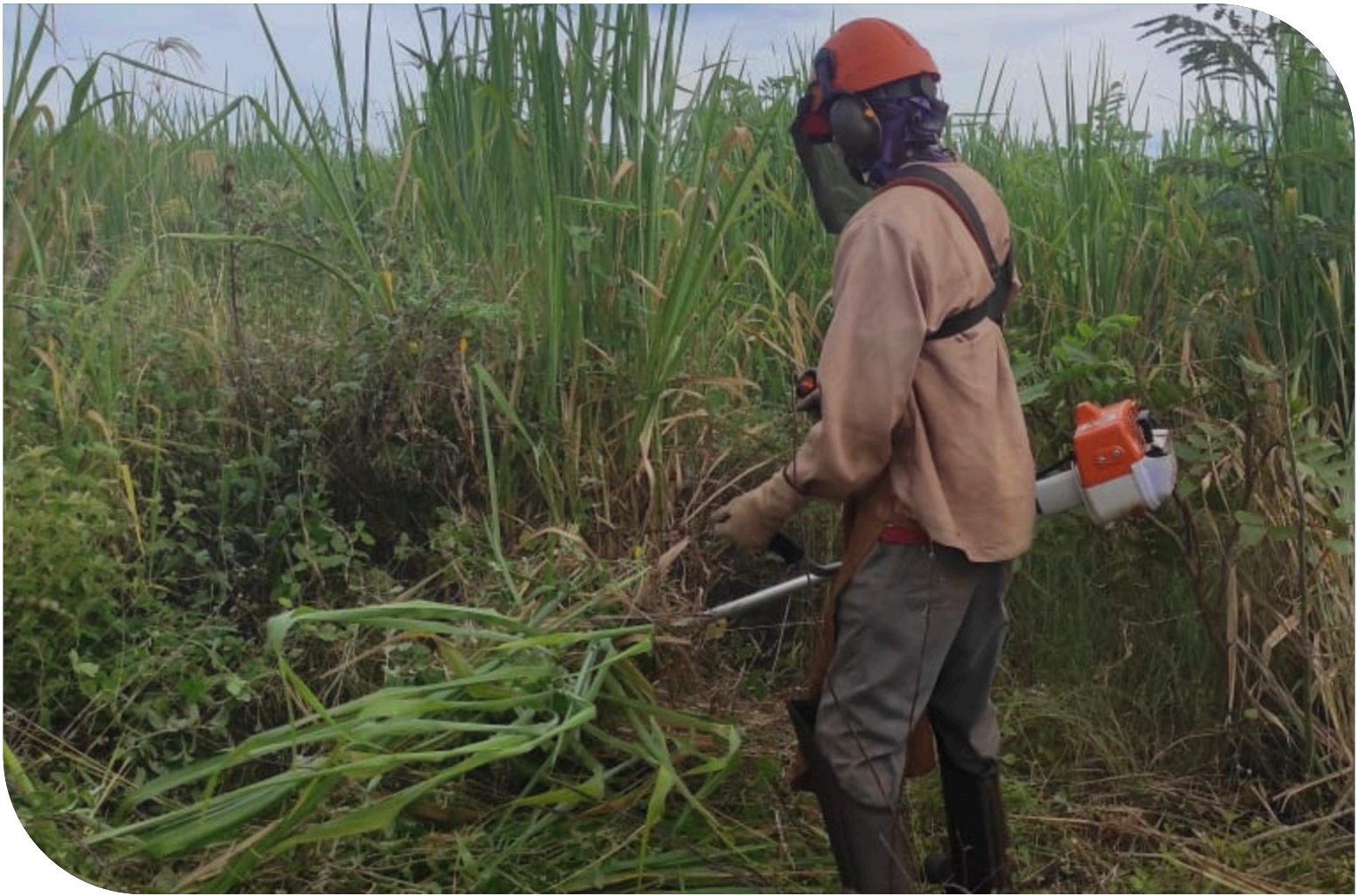
Figura 40. Roçada semimecanizada com roçadeira costal
