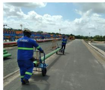
Dispositivo diminui a exposição do colaborador ao risco de prensamento de membros superiores e inferiores, além de realizar a atividade com postura lombar adequada.
