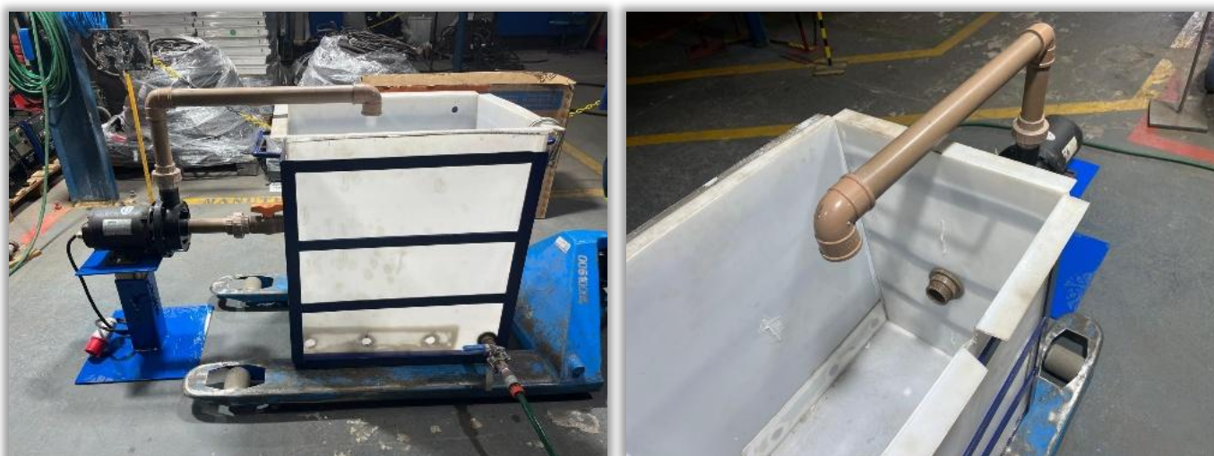
Figuras 88 e 89 – Caixa Bomba Centrífuga
