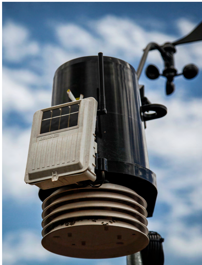
Detalhe da estação meteorológica, que mede temperatura e umidade, direção e velocidade do vento chuva (pluviômetro) e pressão barométrica. Foto: Paulo Moreira
