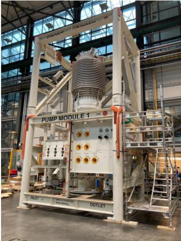
Módulo de bombeio multifásico (MPP) concluindo montagem e testes (Noruega)
