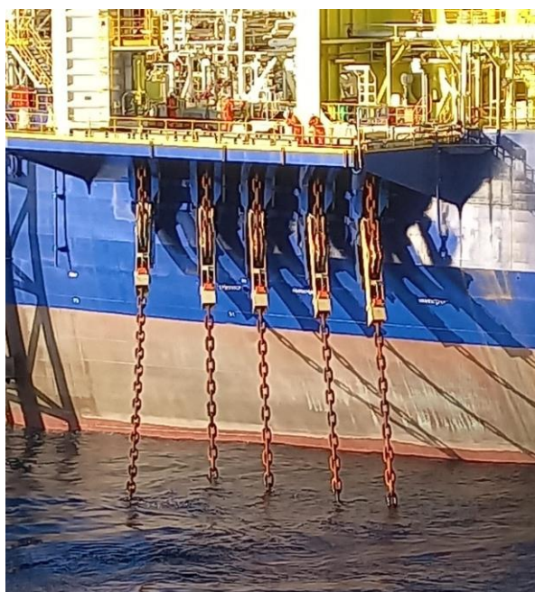
Sistema de ancoragem do FPSO Atlanta em fase final de instalação
