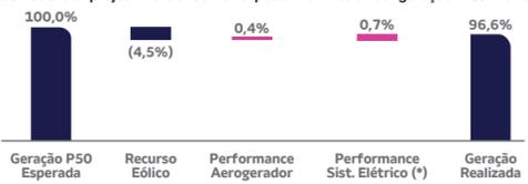
(\*) Sistema Elétrico refere-se ao sistema interno composto pela rede de média tensão (34,5kV), subestação coletora (34,5/320kV), linha de transmissão até a subestação seccionadora (230/500kV).
