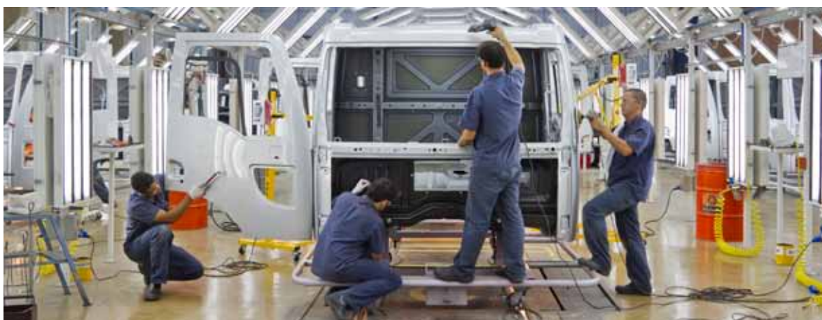
Túnel de luz da pintura – Automotiva Usiminas – Pouso Alegre/MG
