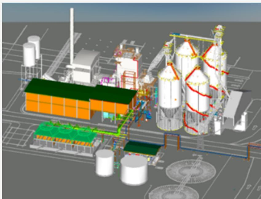
A Central de Cogeração a Biomassa (CCB) terá como combustível a própria casca de arroz gerada na fábrica da Camil, podendo gerar até 12MW de energia (geração bruta máxima) e uma produção de 52t/h de vapor a 45 bar e 460°C para acionamento do turbogerador (TGV), vapor esse proveniente da caldeira aquatubular a biomassa (GV).
