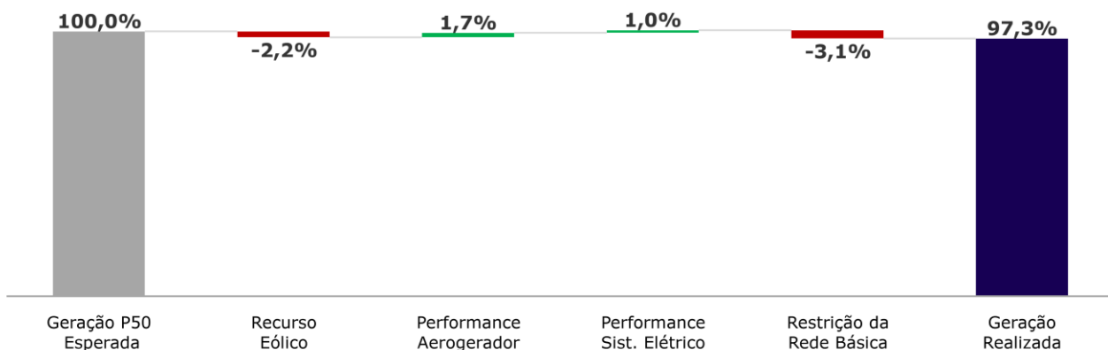
Gráfico 14 – Ventos do Piauí II: Performance do parque eólico no 2T23 quando comparado aos parâmetros técnicos do projeto tendo como expectativa média de geração P50 na base 100
