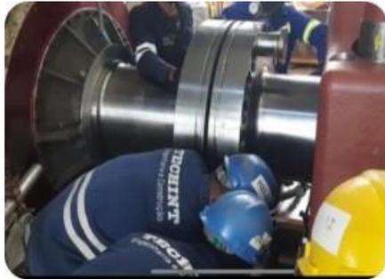
Alinhamento final e realização do *runout* da turbina a vapor
