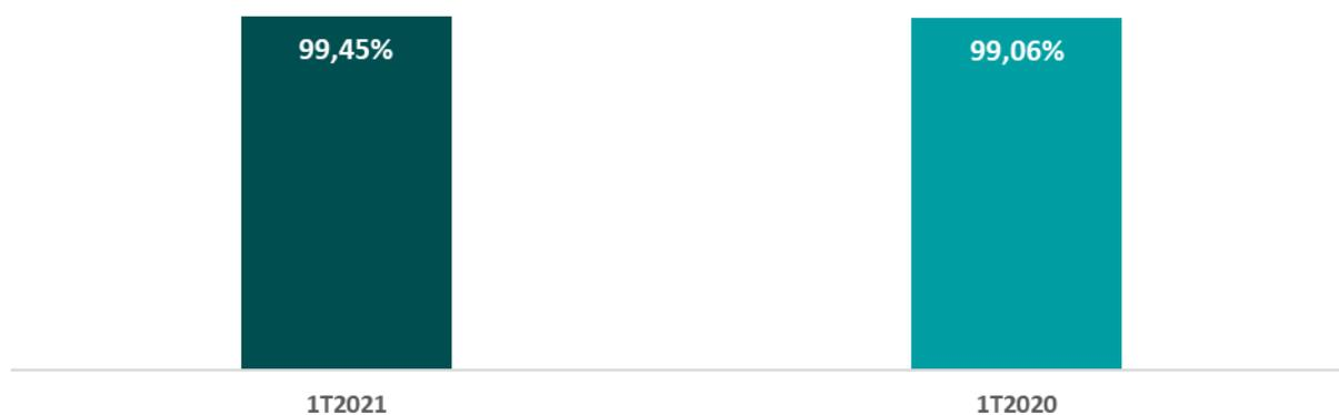
O índice de disponibilidade médio do 1T2021 da UHE Pimental foi impactado em 0,55% por restrição forçada equivalente da limitação de potência da PIMUGH06 no mês de março, com performance dentro do esperado para o período.
