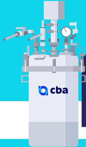
5. Na planta de separação química do ReAl, o PoliAlu é direcionado para o reator com solução alcalina, com uma concentração ideal de soda cáustica, responsável por separar o alumínio do polímero. Esse processo gera hidrogênio verde, uma energia limpa, que não emite CO<sub>2</sub> e pode ser reaproveitada internamente nos processos produtivos da Companhia, reduzindo o consumo de combustíveis fósseis.
