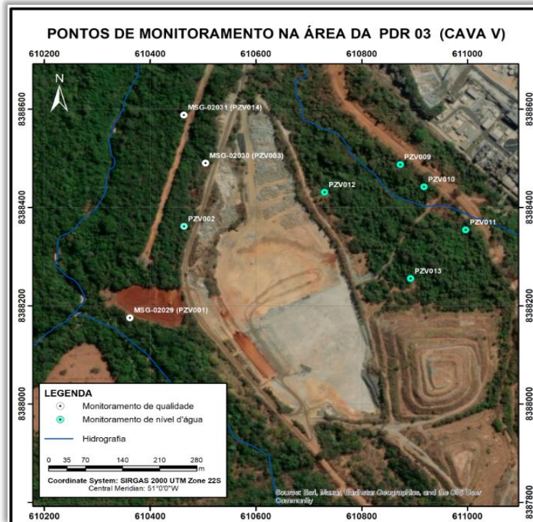
Figura 29: Localização dos instrumentos instalados no Open Pit Corpo V.
