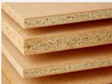
**MDP cru e MDP revestido** com padrões e texturas, feitas com partículas de madeira prensadas, tendo superfície mais resistente quando comparado aos acabamentos convencionais.
