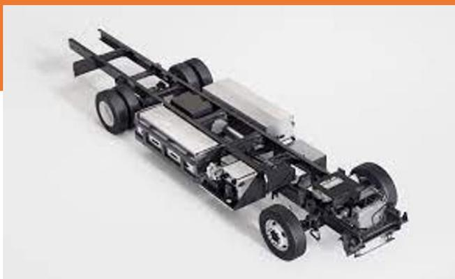
Disposição diferente de tanques e baterias em veículos comerciais
