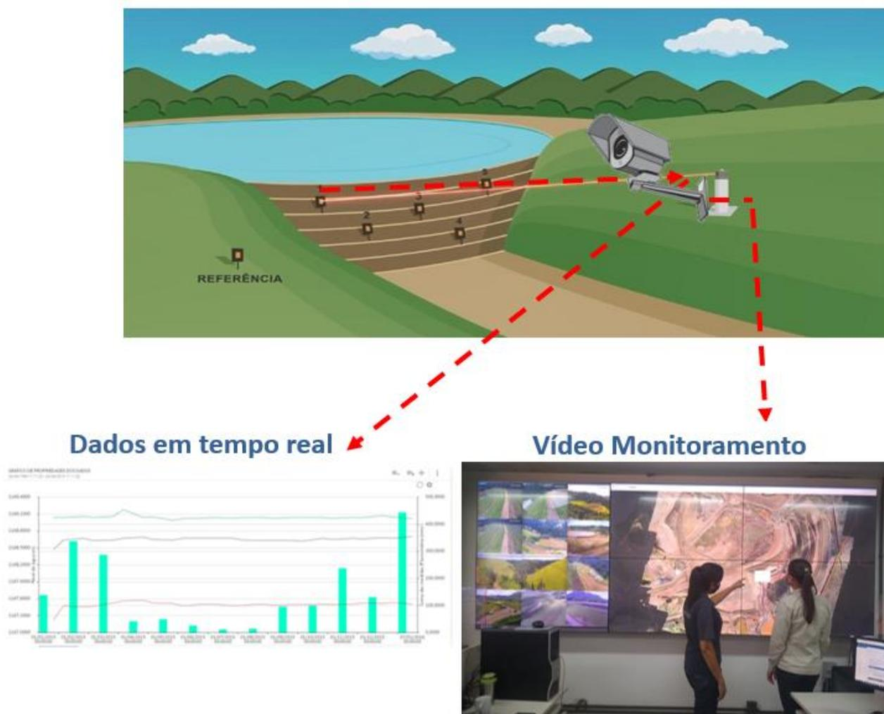
**Figura 15-2 – Esquema da automatização do monitoramento**
