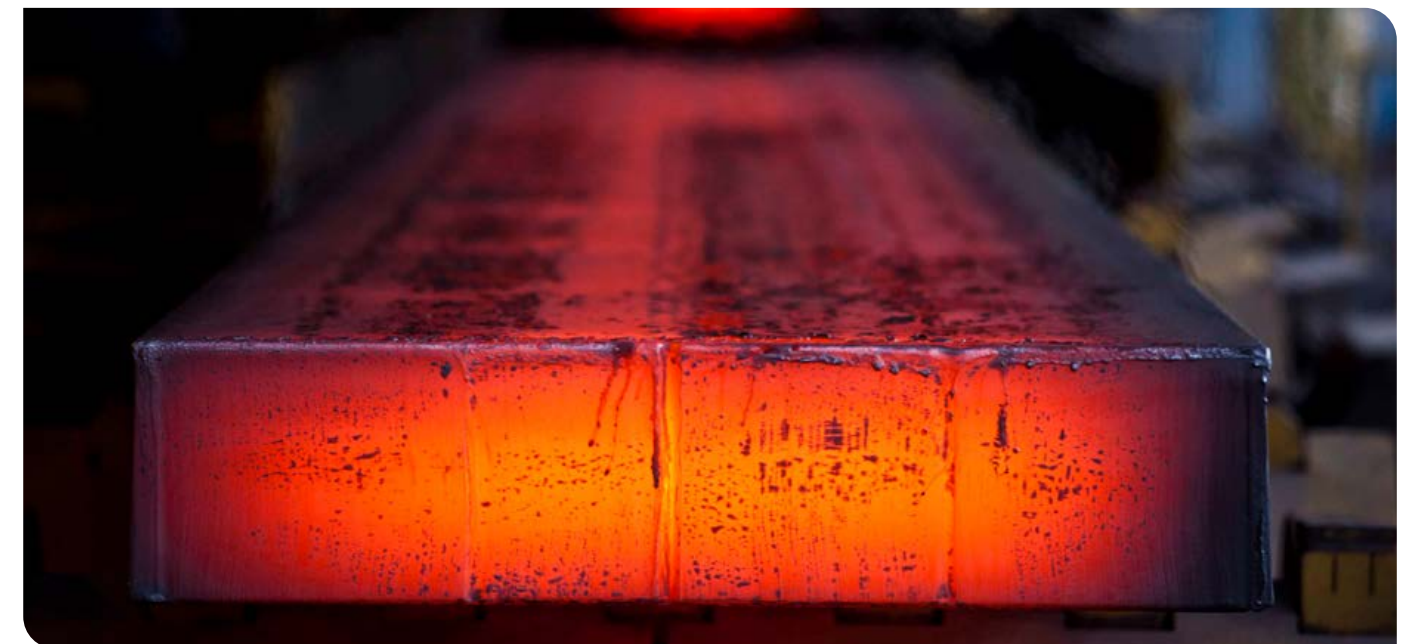
Placa de aço na linha de Laminação a quente da Usina Presidente Vargas em Volta Redonda
