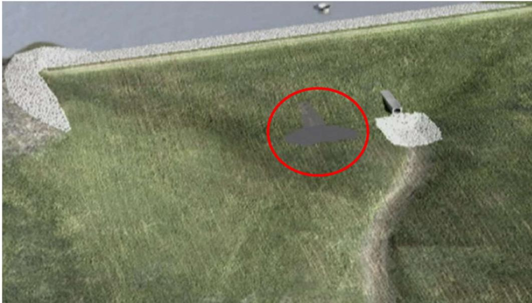
**Figura 7.1 – Simulação de surgência observada no talude de jusante.**
