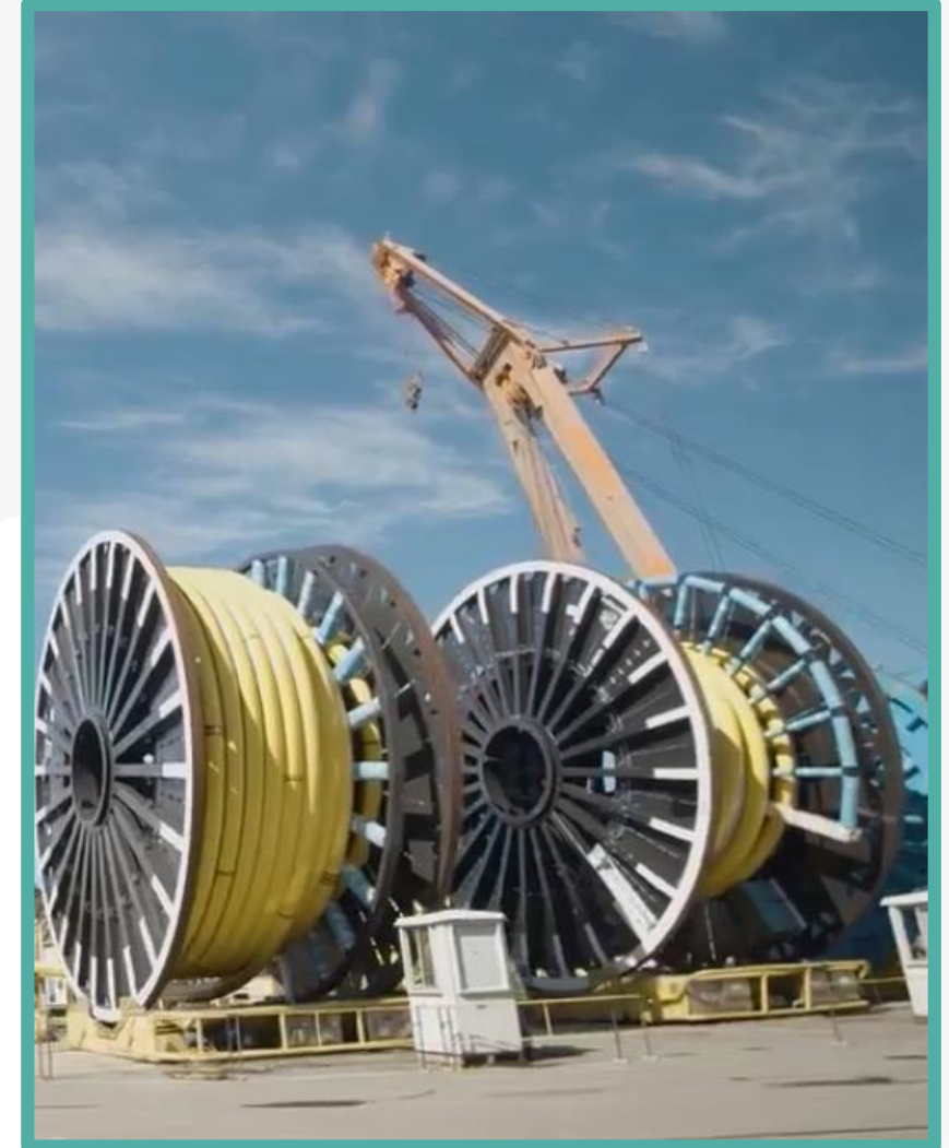
Spools com as linhas flexíveis do tieback , antes da mobilização.
