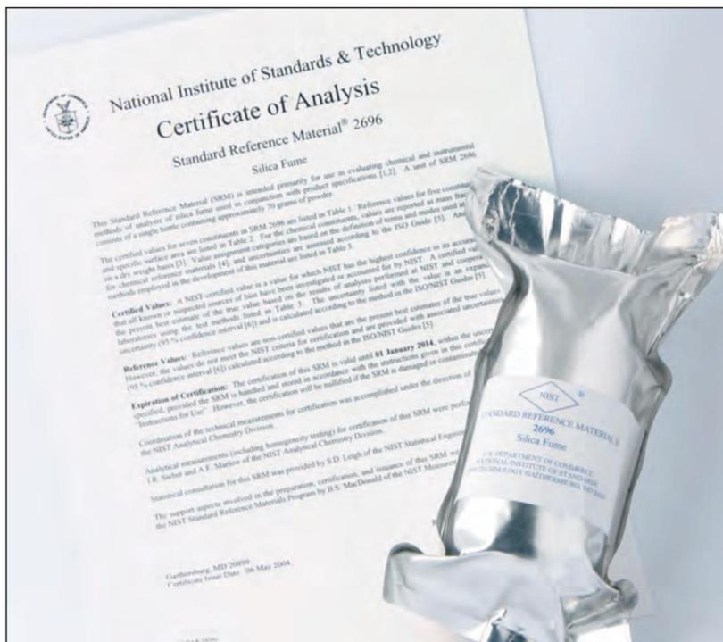
FIGURA 4.5. Material de referência padrão de sílica ativa (SRM 2696) disponível no National Institute for Standards and Technology. Verifique os sites da SFA ou do NIST, conforme listado no texto, para obter instruções sobre como solicitar este material.
