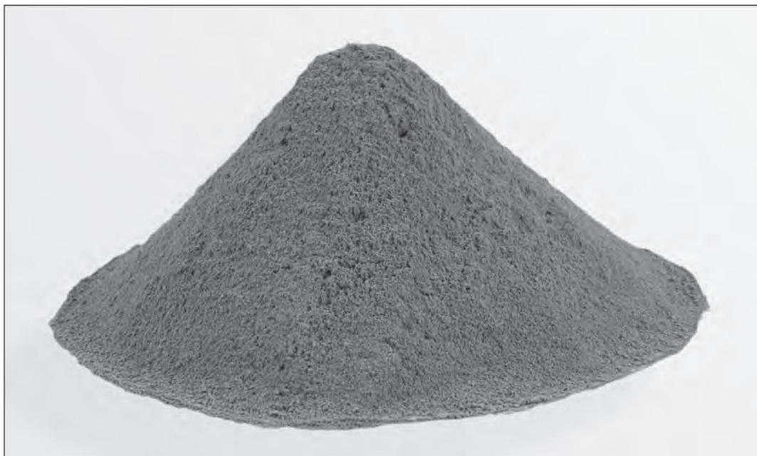
**FIGURA 1.1.** Sílica ativa como produzida. É assim que o material fica depois de coletado.
