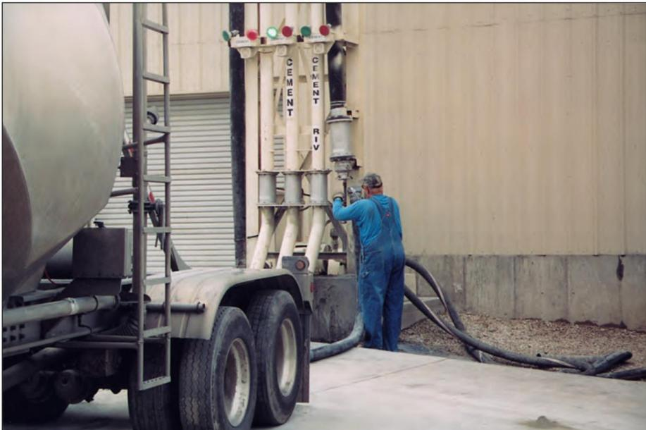
FIGURA 6.5B. Conectando a mangueira de borracha do tanque à mangueira de enchimento de borracha do silo.
