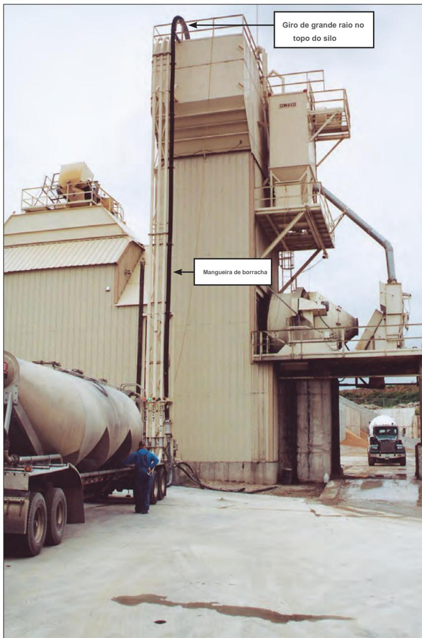
FIGURA 6.3. Descarga de fumaça de sílica densificada a granel em um silo. Observe a mangueira de borracha e a curva de grande raio no topo do silo.
