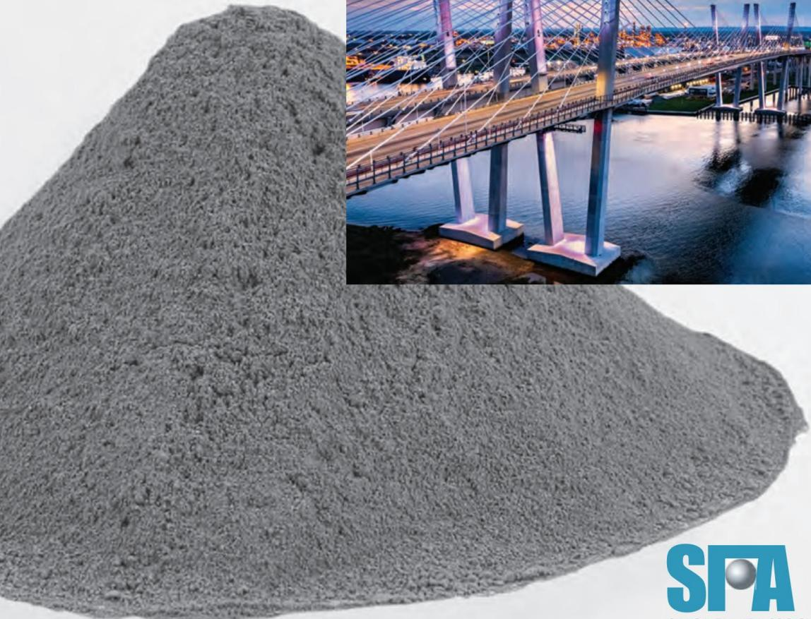
*Foto da capa: A ponte New Goethals, atravessando o estreito de Arthur Kill entre Elizabeth, Nova Jersey e Staten Island, Nova York. A sílica ativa foi usada para produzir 397 vigas de concreto de alta resistência. Cada viga tinha 53,6 m de comprimento, 1,1 m de largura e pesava 100 toneladas.*
