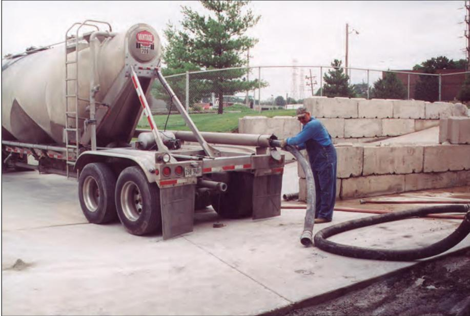
FIGURA 6.5A. Mangueira de borracha usada para transferir sílica ativa do caminhão-tanque para o silo do produtor.
