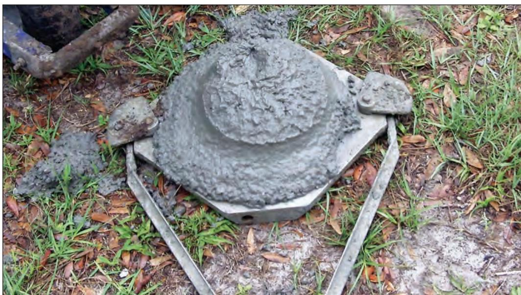
FIGURA 5.2. O abatimento do concreto colocado na cúpula do tanque foi de aproximadamente 200 mm.
